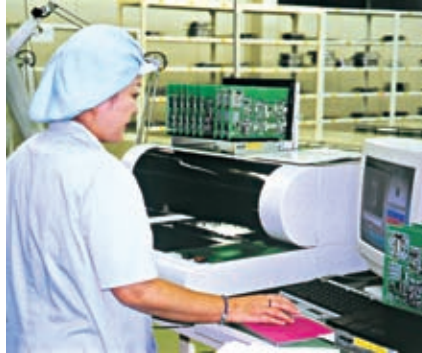
外観検査装置の画面で基板をチェック
