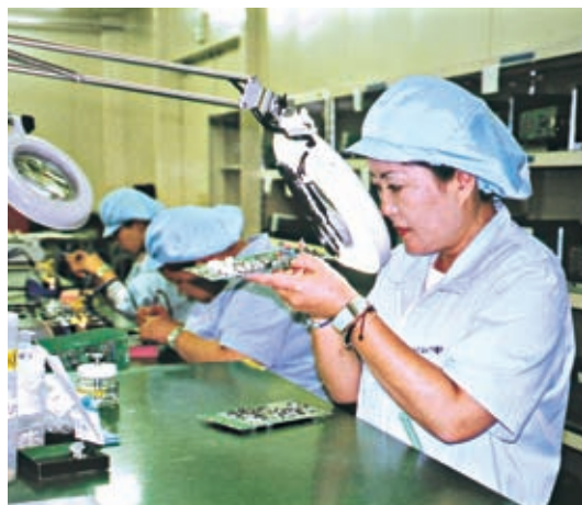
基板を手に部品の装着を目視検査
