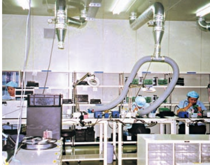
後工程の作業 右の2人は、はんだ付け
